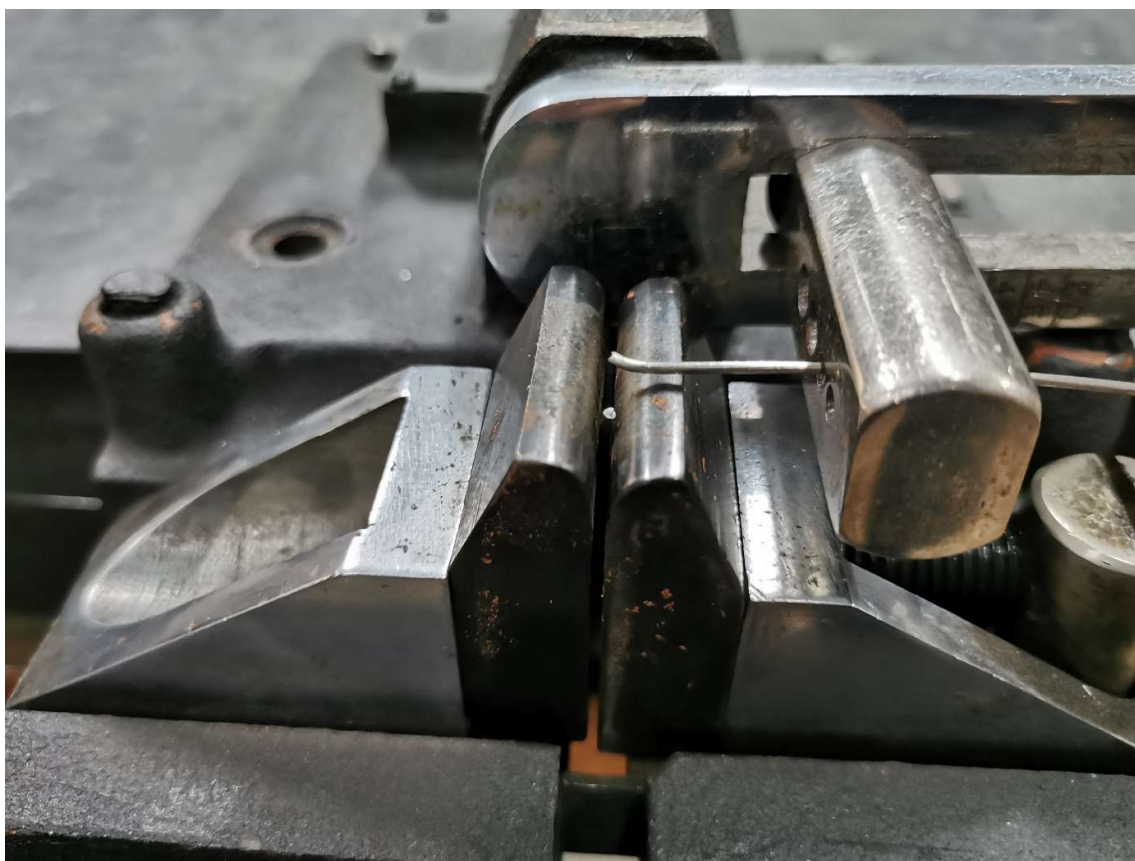
Rysunek 7.2. Próbką po próbie dwukierunkowego przeginania
