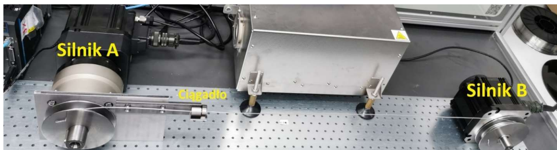
Rysunek 5.1. Silniki programowanej ciągarki
